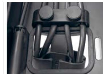
4 Fissare i cavi nella vaschetta portacavi con avvolgicavo e listelli magnetici. A seconda del rispettivo diametro inserire i cavi nel dispositivo di ancoraggio e avvitare la catena con la parte finale della catena a maglie alla vaschetta portacavi.
